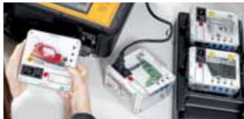
Gracias a la baja tensión de nuestra Safety Measures Board, los alumnos pueden poner a prueba de forma segura la seguridad de los sistemas y dispositivos eléctricos (por ejemplo, sistemas de red y medidas de protección).
